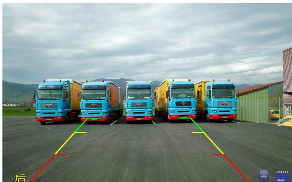
当倒车信号线触发后，会自动显示通道 4 的摄像头视图，同时显示倒车线。
